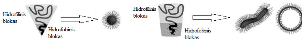
3.12 schema. Nuo hidrofobinio ir hidrofiliinio segmentų santykio priklausantys polimerų agregavimosi ypatumai [278]
