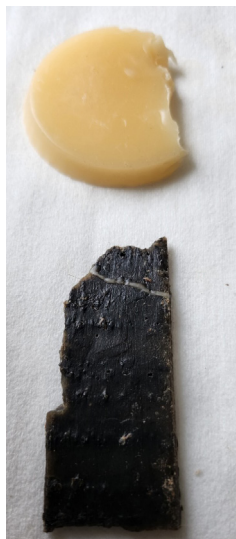
7 PAV. Restauracinių bičių vašku suklijuotas su- skilęs didžiausias vaško fragmentas
