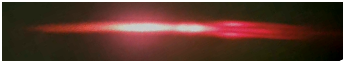
4.8 pav. Sinchroniškai kaupinamo parametrinio šviesos generatoriaus išvadinės spinduliuotės pluošto išskleisto difrakcine gardele erdvinis skirstinys.
