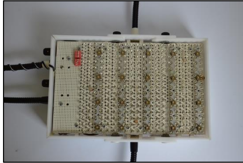
6 pav. Specialiosios paskirties medicinos prietaiso „IMC-Light“ vaizdas iš vidinės, spinduliuotę skleidžiančios, pusės
