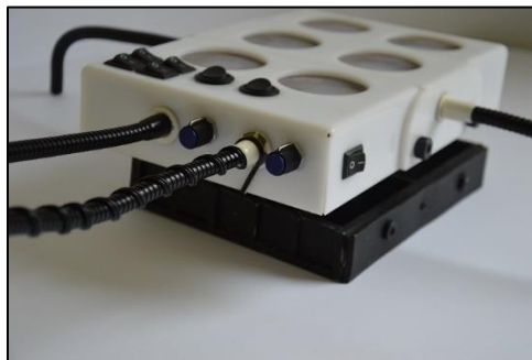
10 pav. Specialiosios paskirties medicinos prietaisas „IMC-light“, uždėtas ant dėžės su atskirais narveliais, skirtos pelėms apšvitinti
