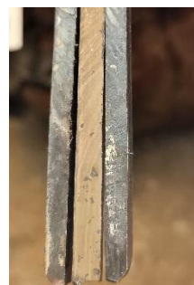
pav. 71. Trys raštuoto plieno strypai sudedami prieš kalavijo šerdies suvirinimą.
