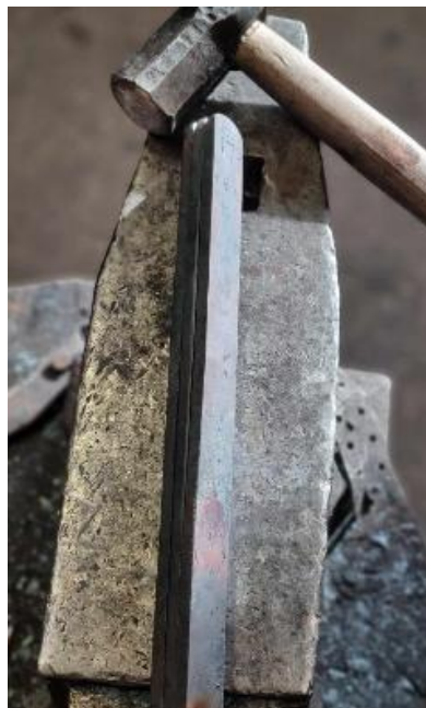
pav. 57. Trys metalo sluoksniai, formuojantys geležtės šerdį.
