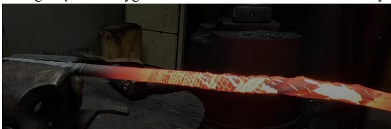
pav. 65. Raštuoto plieno formavimo etapas - strypo tordiravimas.
