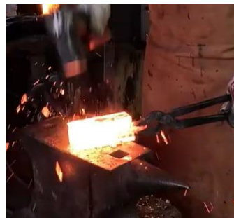
pav. 64. Pirmas metalo sluoksnių suvirinimo etapas - kalama ranka.
