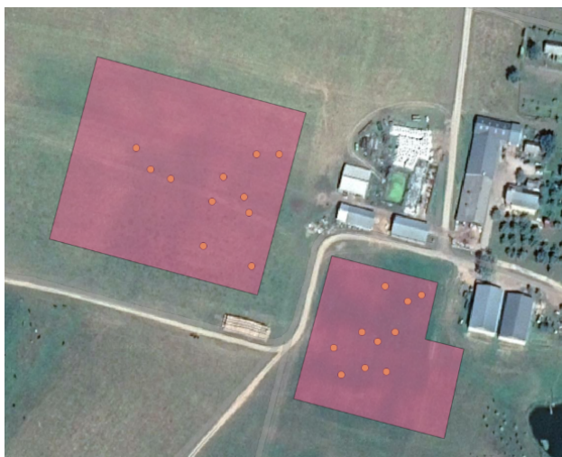
12 pav. Skenavimų zona sudaryta iš dviejų aikštelių, kuriose užkasti įvairių svorių bei formų nesprogę sprogmenys. Sprogmenų vietos pavaizduotos oranžinės spalvos apskritimais.
