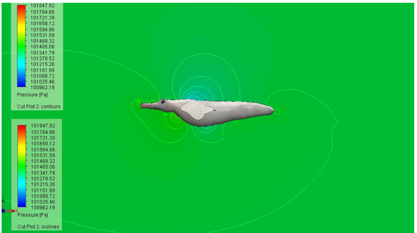
127 pav. Albatroso sklandmens slėgio pasiskirstymo spektras skaičiuotinėje erdvėje, koordinatinių plokštumoje YX. AoA = 10^\circ . V_x = 20 m/s
