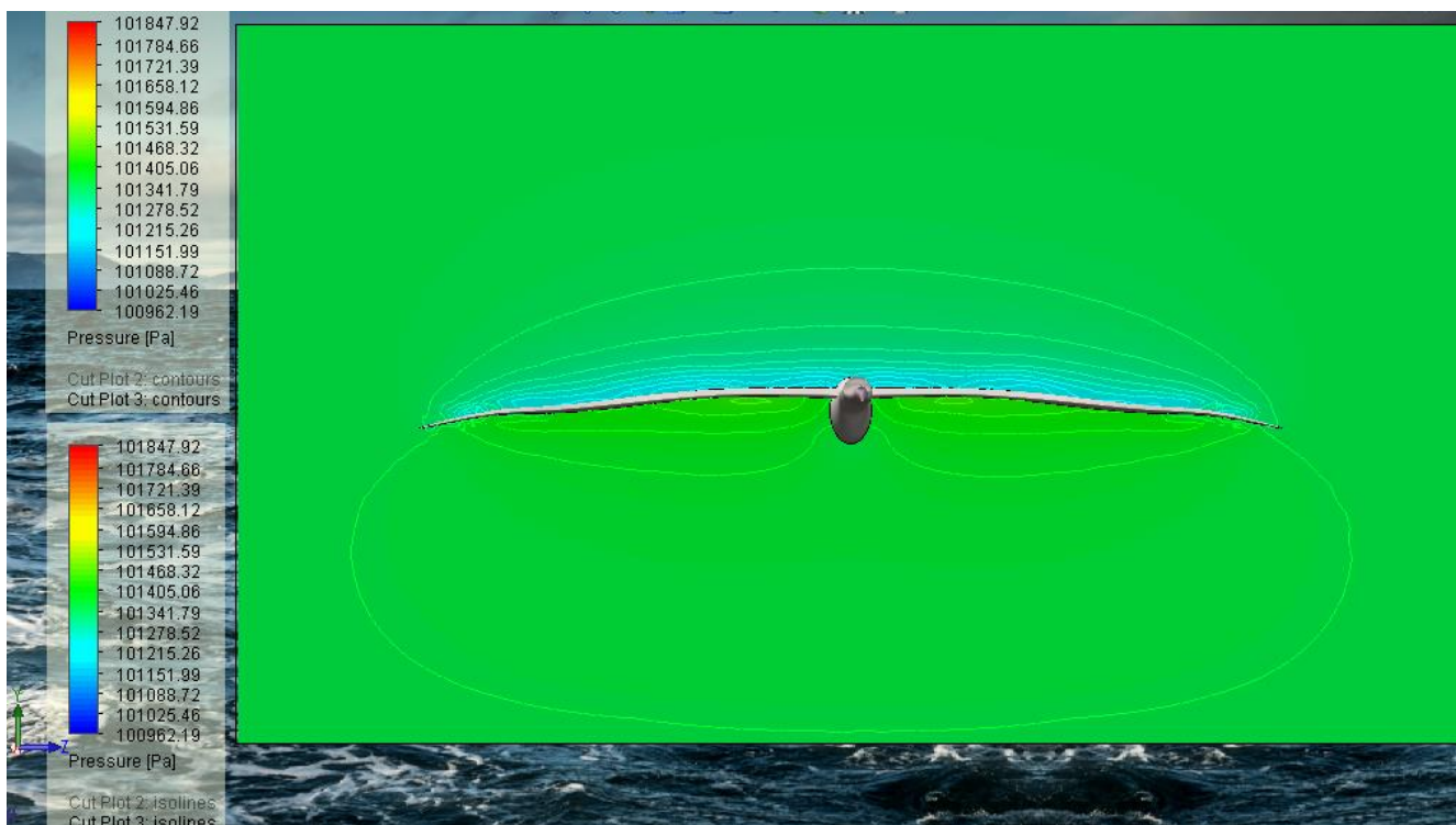
53 pav. Albatroso sklandmens slėgio pasiskirstymo spektras skaičiuotinėje erdvėje, koordinatinių plokštumoje YZ. AoA=10^\circ . V_x = 20 m/s
