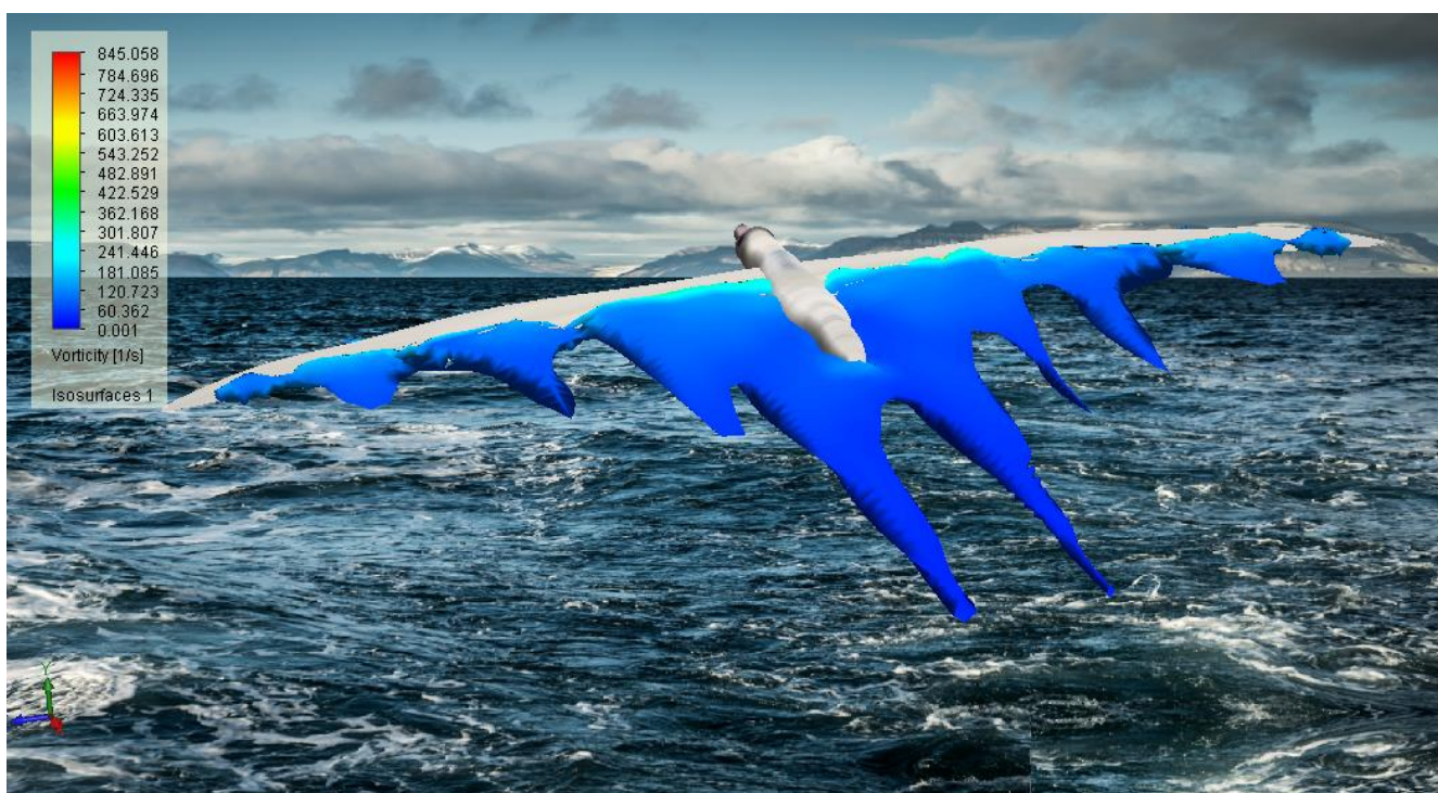
59 pav. Albatroso sklandmens turbuletinių oro srovių spektras. AoA=10^\circ . V_x = 20\text{ m/s}
