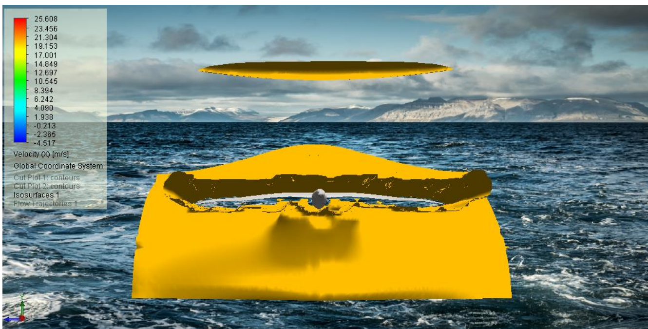
129 pav. Albatroso sklandmens konstrukciją aptekancio oro srauto greičių pasiskirstymo spektras apribotoje skaičiuotinėje erdvėje, koordinacių plokštumoje YX iš galo. AoA = 10^\circ . V_x = 20 m/s
