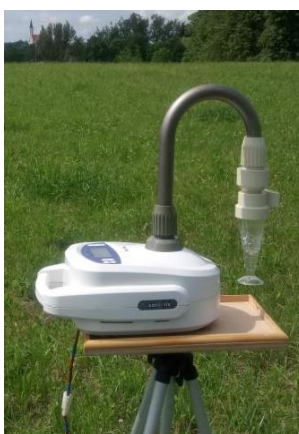
4 pav. Cikloninė oro gaudyklė Coriolis
