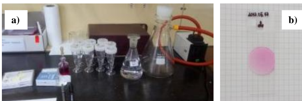
8 pav. 10 min. oro mėginių paruošimas identifikavimui mikroskopu (a – naudotos priemonės, b – paruoštas mėginys)
