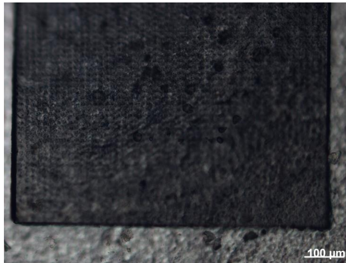
16 pav. Pavyzdys gero GaN sluoksnio atskyrimo nuo safyro padėklo. Pavyzdys darytas su storesne GaN danga.
