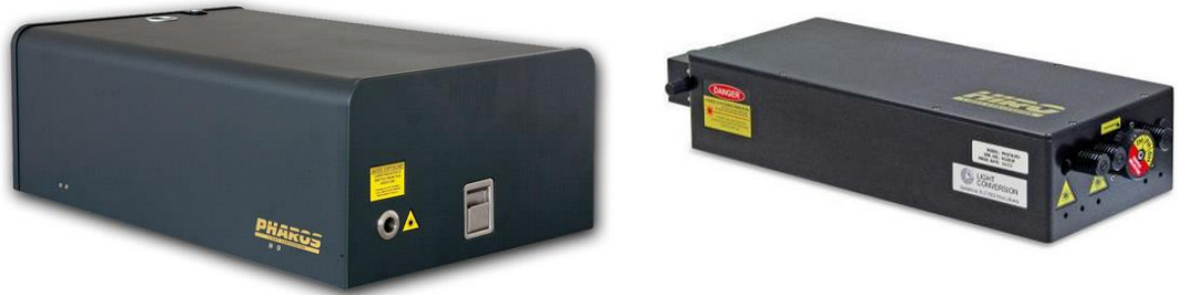
6 pav. Eksperimente naudotas „Pharos“ lazeris ir trečios harmonikos generatorius „Hiro“.
