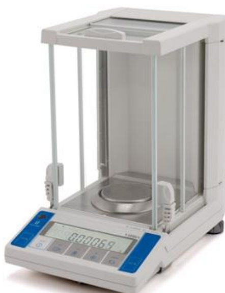
8 pav. Analitinės skaitmeninės svarstyklės
