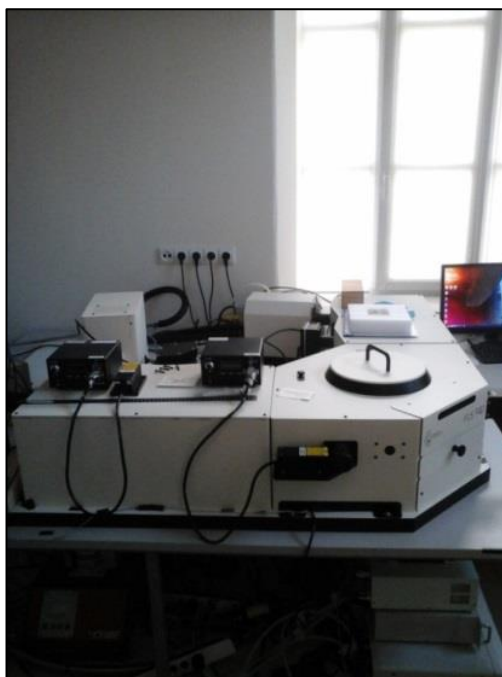
7 pav. Edinburgh Instruments FLS980 spektrometras.
