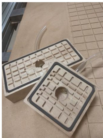
54 pav. Vakuuminio stalo fragmentas bei du vakuuminiai laikikliai
