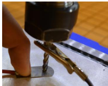
56 pav. Frezos padėties nustatymo virš ruošinio paviršiaus sistema
