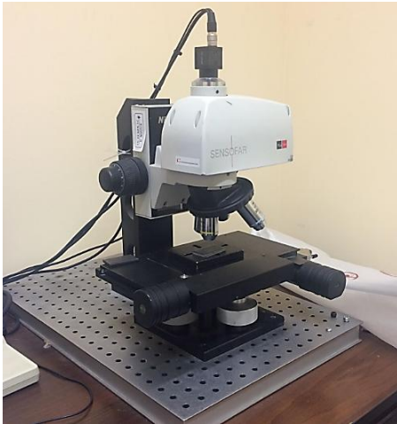
2.3 pav. Optinis profilometras „SensoFar PL \mu 2300“ kairėje ir jo principinė schema dešinėje [28].
