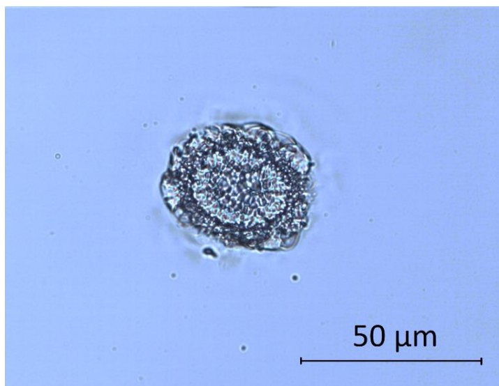
5 pav. Poliruoto optinio pagrinduko paviršiaus lazerinė pažaida
