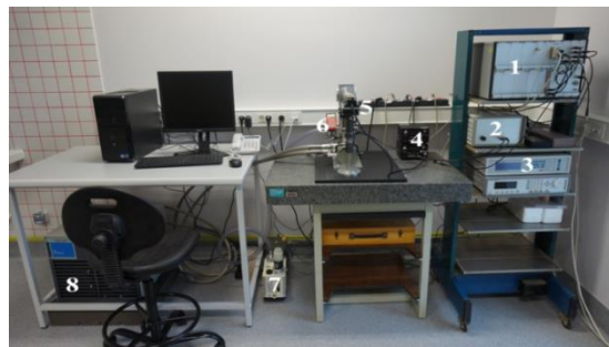
3.8 pav. HERA DLTS System 1030 spektrometro blokinė schema DLTS matavimams (kairėje) ir bendras spektrometro vaizdas (dešinėje). 1 - pagrindinis DLTS modulis, 2 - talpos tiltas, 3 - temperatūros stabilizatorius, 4 - lazerio valdiklis, 5 - lazerio šviesolaidis, 6 - helio kriostatas, 7 - vakuuminis siurblys, 8 - kompresorius.
