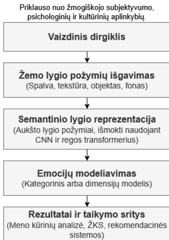
S.1 pav.: Kiekvienas etapas atitinka pagrindinį VEA proceso komponentą – nuo požymių gavimo iki emocijų klasifikavimo, išryškinant duomenų srautą ir tarpusavio priklausomybes emocijų analizės procese.
