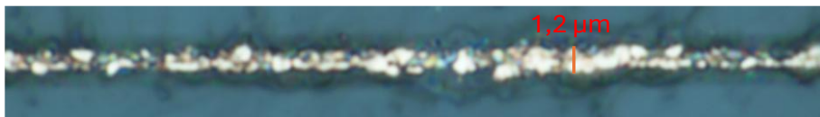
54 pav. Siauriausias Beselio pluoštu ant PET polimero suformuotas takelis (impulsų pasikartojimo dažnis – 50 kHz, rašymo greitis – 1,25 mm/s (impulsų persiklojimas – 92,9 %), Beselio smailės energijos tankis 0,4 \text{ J/cm}^2 )
