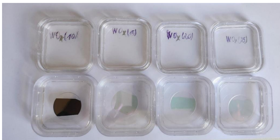
15 pav. Volframo oksido bandiniai po magnetroninio dulkinimo su skirtinga deguonies koncentracija.
