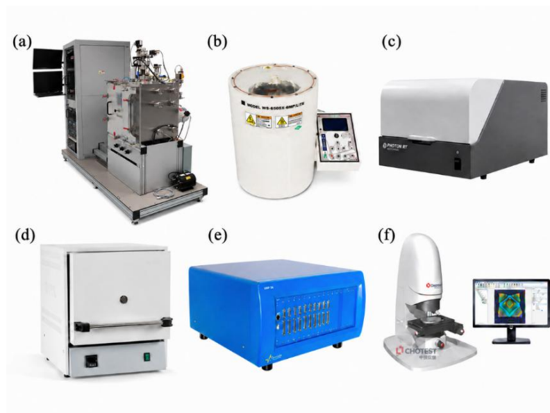
20 pav. Naudotų įrenginių nuotraukos: (a) magnetrono sistema; (b) išcentrinis dengiklis (spin coater); (c) spektrofotometras; (d) atkaitinimo krosnelė; (e) daugiakanalis potenciostatas; (f) profilometras.
