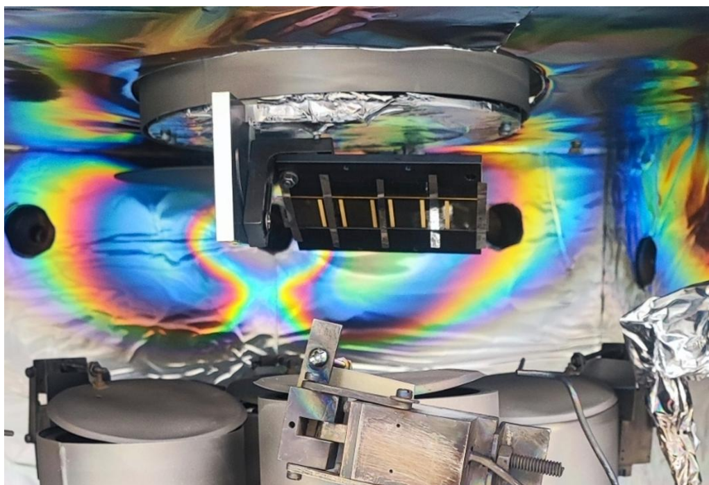
25 pav. Magnetrono kamera - ruošiamasi garinti volframo oksidą.
