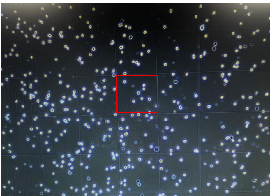
6 paveiklas. SK-MEL-28 ląstelių skaičiavimas Neubauer'io kameroje, naudojant tripano mėlio dažą. Raudonu rėmeliu pažymėtas vienas iš Neubauer'io kameros skaičiavimo kvadratų, naudotų ląstelių skaičiavimui. Nuotrauka paimta iš asmenių archyvų.
