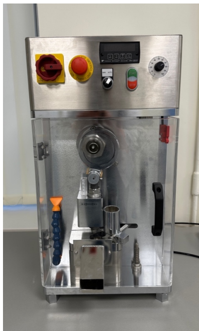
18 pav. Ekscentrinė tiesioginio tablečių presavimo mašina – Erweka EP – 1, Vokietija.
