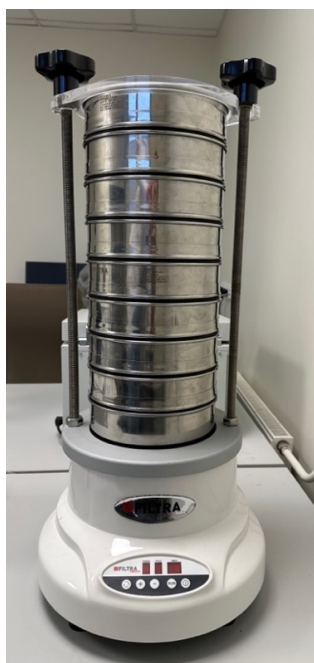
16 pav. Analitinių sietų rinkinys – FILTRA VIBRACION FTL-0200 , Ispanija.
