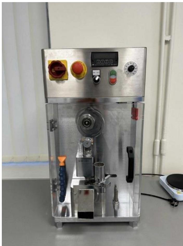
8 pav. Tabletavimo mašina Erweka EP-1, Vokietija.
