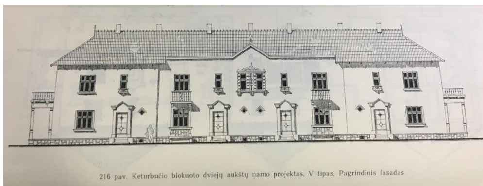
216 pav. Keturbučio blokuoto dviejų aukštų namo projektas. V tipas. Pagrindinis fasadas 23 iliustracija. Keturbučio blokuoto dviejų aukštų namo projektas (Spelskis Antanas, Miestų sodybinės statybos architektūra , Vilnius, 1955, p. 208).
