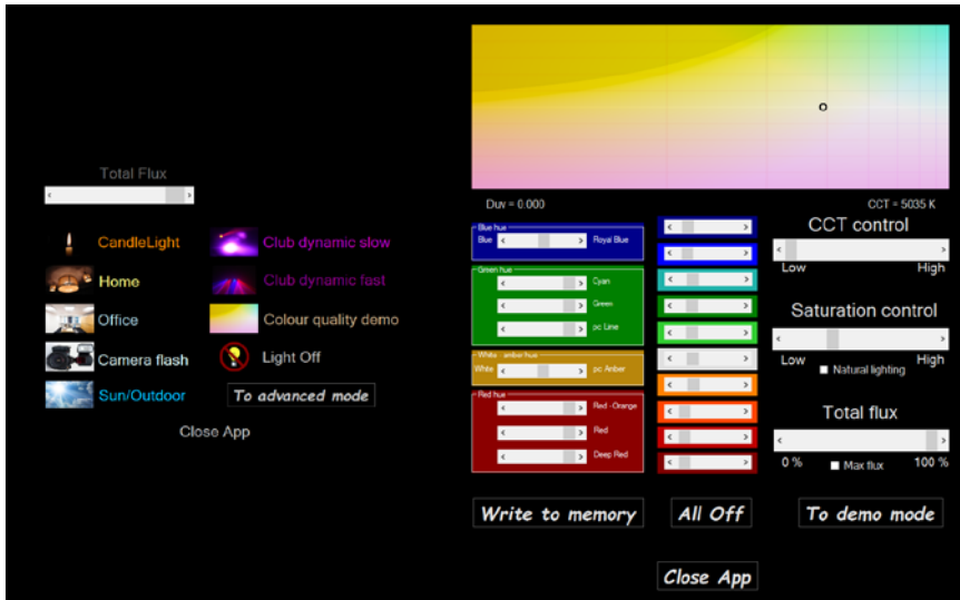
4.11 pav. Šviestuvo valdymo programos vartotojo sąsajos langai. Kairėje - demonstracinė versija, dešinėje – detalus apšvietimo valdymas.
