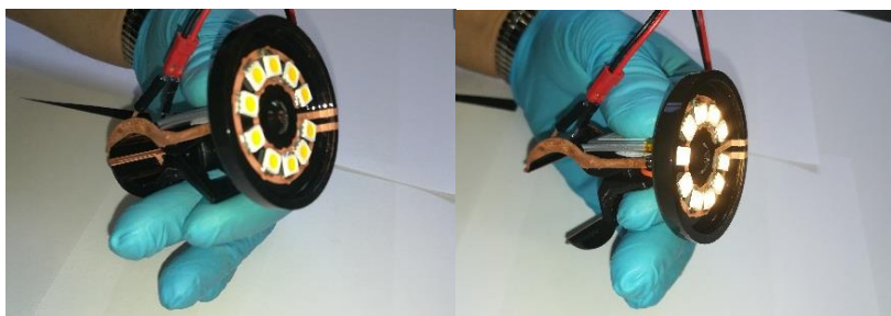
17 pav. Demonstratorius pagamintas, naudojant SSAIL technologiją – LED prožektorius su laidumo takeliais ant 3D PA6 paviršiaus.
