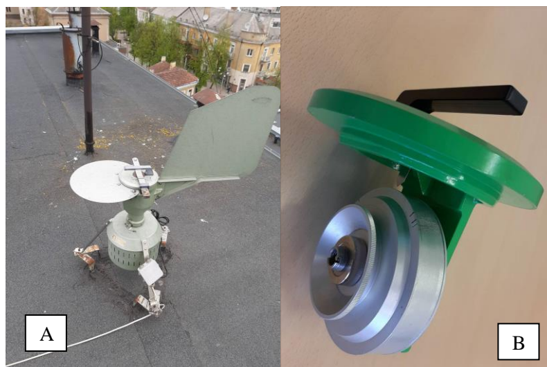
8 pav. Hirst tipo žiedadulkių ir sporų tūrinė gaudyklė (A) ir jos ištraukiamasis dangtis su sukamu būgnu (B)
