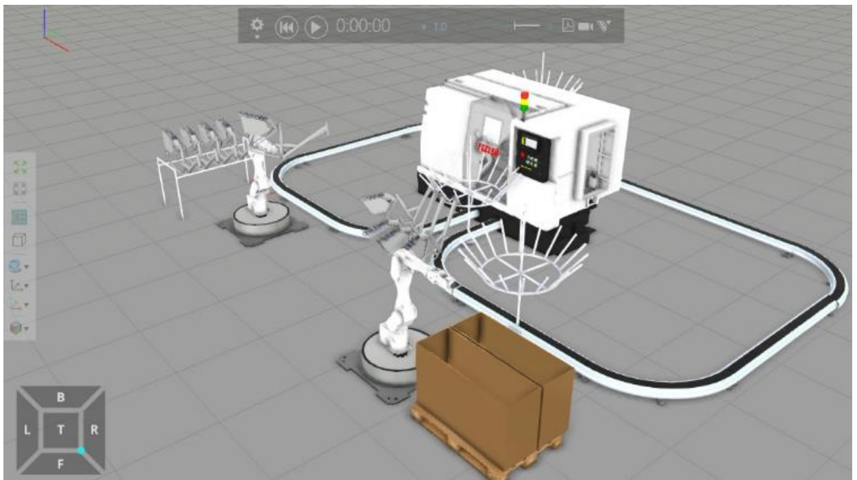
3.6.3 pav. Modernizuota srautinio valymo šratais darbo vieta ( Robotas-robotas ), sukurta su Visual Components (priekis)
