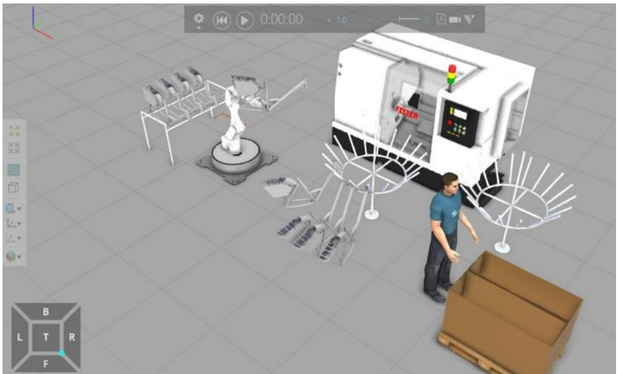
3.6.1 pav. Modernizuota srautinio valymo šratais darbo vieta ( Robotas-žmogus ), sukurta su Visual Components (priekis)
