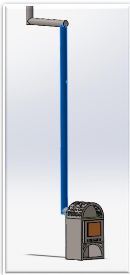
2.2 pav. Židinio-krosnelės Vienybė-06 Solidworks eskizas su pažymėta tiriamojo dūmtraukio dalimi
