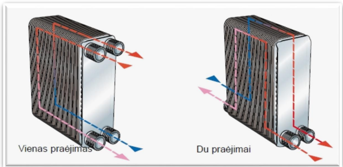
1.1 pav. Plokšteliniai lituoti šilumokaičiai
