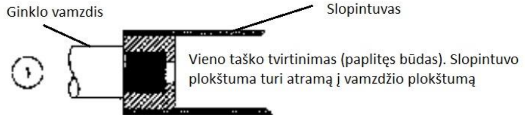
2.3 Pav. Vieno taško tvirtinimas, atrama į plokštumą
