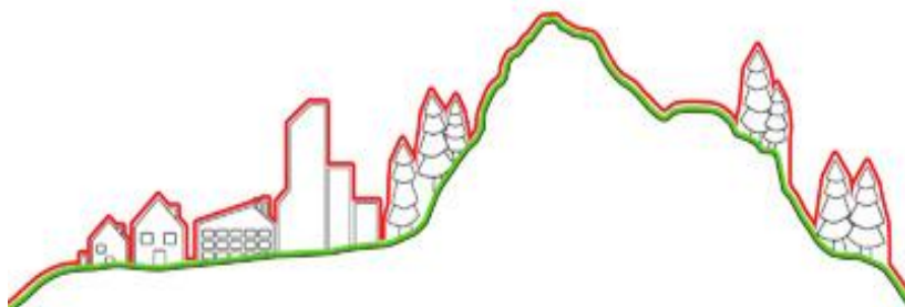
2 pav. Skaitmeniniai aukščių modeliai. Raudona spalva pažymėtas skaitmeninių aukščių modelių (SPM) principinis Lidar skenavimo objektas, žalia spalva pažymėtas skaitmeninio reljefo modelio (SRM) principinis Lidar skenavimo objektas. Paimta iš: < http://www.computamaps.com/newsletter/3-3/newsletter3-3.html > [žr. 2016-08-19].
