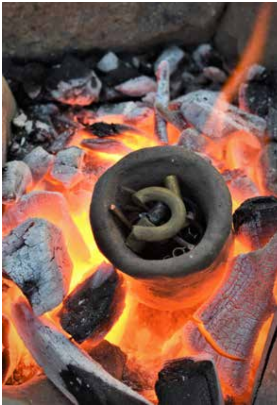
7 pav. Žaidras pirmo metalo liejimo bandymo metu. V. MICELICAITĖS NUOTR.
