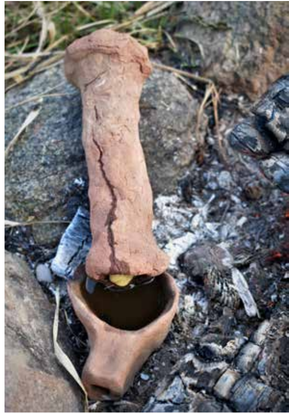
9 pav. Liejimo formos išdegimas ir vaško surinkimas. V. MICELICAITĖS NUOTR.
