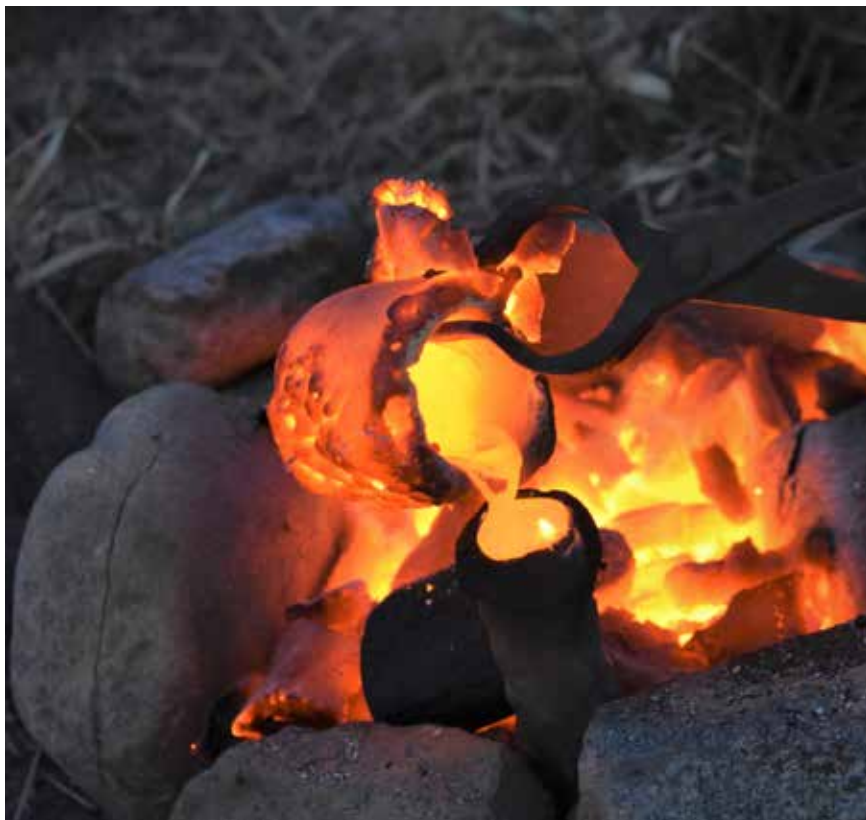
11 pav. Metalo pylimas į liejimo formą.
