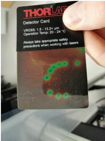
25 pav. Užregistruotas lazerio pluošto profilis CW veikoje ant Thorlabs-VRC6S kortelės
