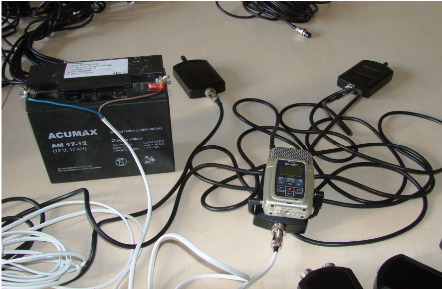
3 pav. Detektoriai „Lunabat“, garso registratorius Edirol R-09, prijungti prie akumuliatoriaus.
