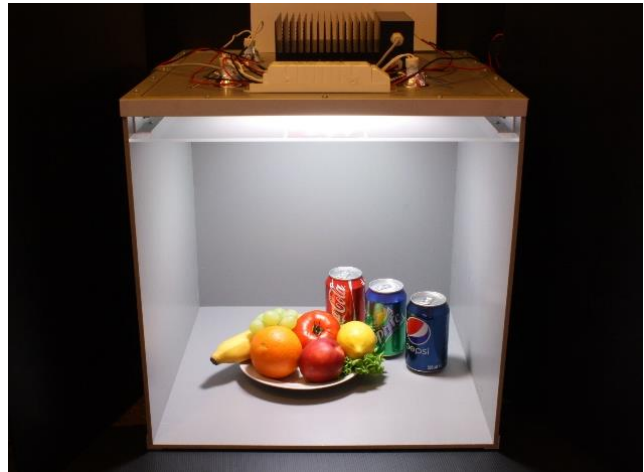
2.2 pav. Eksperimentinė instaliacija su derinamu RAGB šviesos šaltiniu viršuje ir viduje esančiais apšviečiamais objektais [P5].
