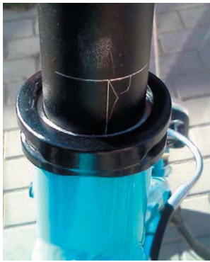
4 pav. Dėl tinkamai neišvalyto vamzdžio subraižytas balnelio laikiklis
