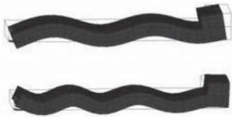
9 pav. Pjezoelektrinio VK, maitinamo rezonansiniais 30,19 kHz ir 63,2 kHz dažniais, virpesių išlenkimas [7]
