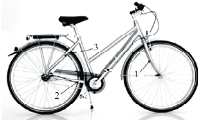
4 pav. Jutiklių išdėstymo schema: 1, 2, 3 – jutiklių tvirtinimo vietas
