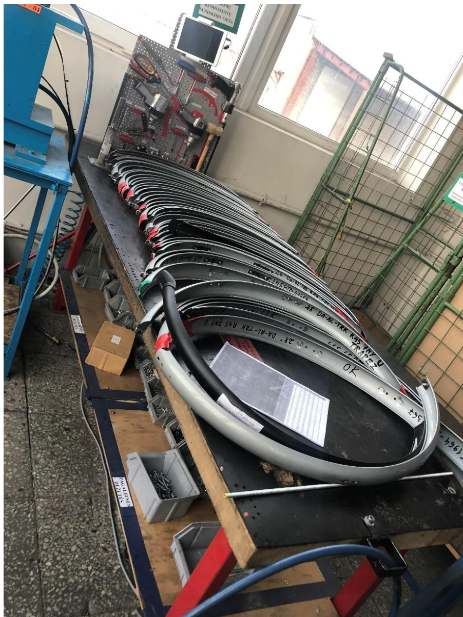
2.2 pav. Dviračių purvasaugių gręžimo operacijos prieš konvejerį darbo vieta
