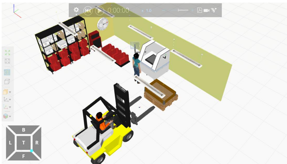
3.5.2 pav. Modernizuota darbo operacija, dviračių purvasaugių kirtimas prieš konvejerį (Įrenginys-žmogus), 2 projekcija
