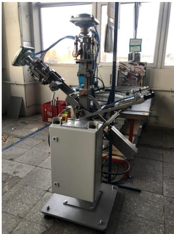
3.2.1 pav. Dviračių purvasaugių kirtimo prietaisas
