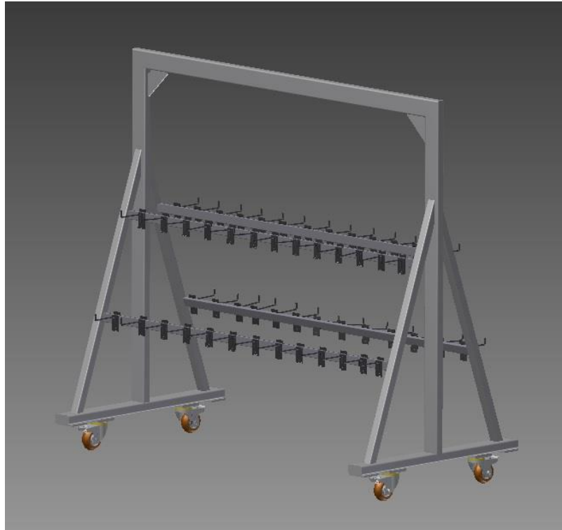
3.1.1 pav. Dviračių purvasaugių šablonų stendas
