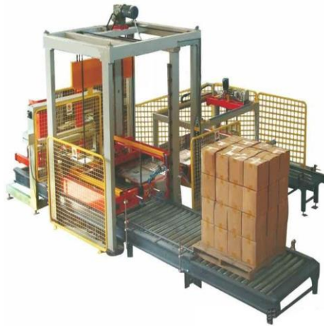
1.3.1 pav. Konvejerinė paletavimo sistema
