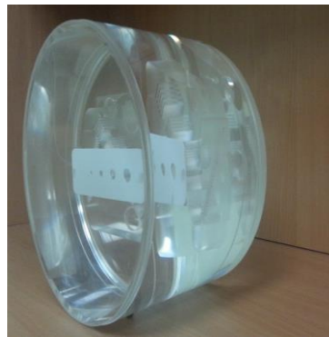
12 pav. Triukšmams generuoti pasirinktas cilindrinis 215 mm skersmens vaizdo kokybę užtikrinantis PMMA fantomas
