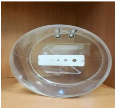
12 pav. Triukšmams generuoti pasirinktas cilindrinis 215 mm skersmens vaizdo kokybę užtikrinantis PMMA fantomas
