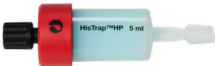
pav. 2.4 HiTrap™ IMAC kolonėlė, kurios turis 5 mL (1,6 x 2,5 cm). Kolonoje yra Sepharose™ 6 Fast Flow sorbentas, Rekomenduojamas pratekėjimo greitis 5 mL/min. (pritaikyta iš Sigms Aldrich tinklapio).
