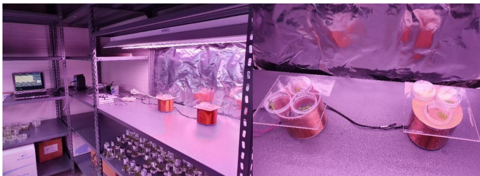
8 pav. L. minor auginimas ant įrangos, sukeliančios EML. L. minor mėginiai auginami ant ritės (10 cm skersmens ir 10 cm aukščio).
