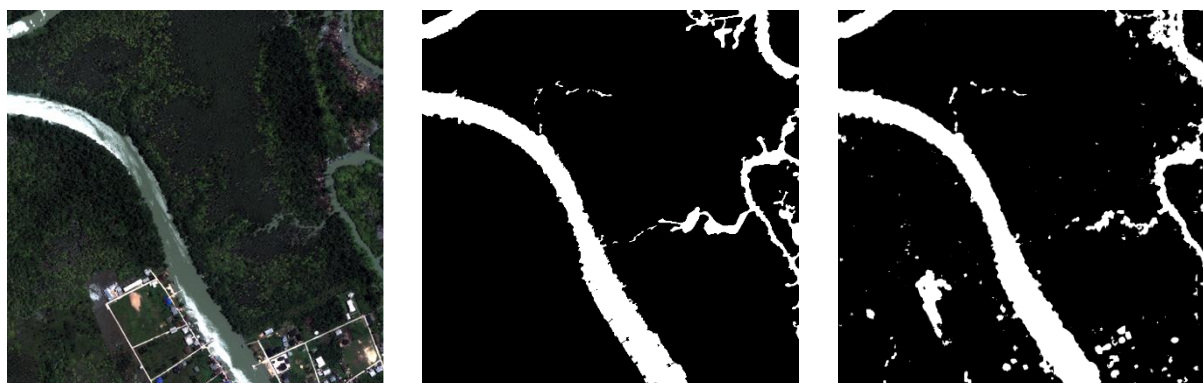
19 pav. SegCaps vandens telkinių segmentavimas (geriausias atvejis)
