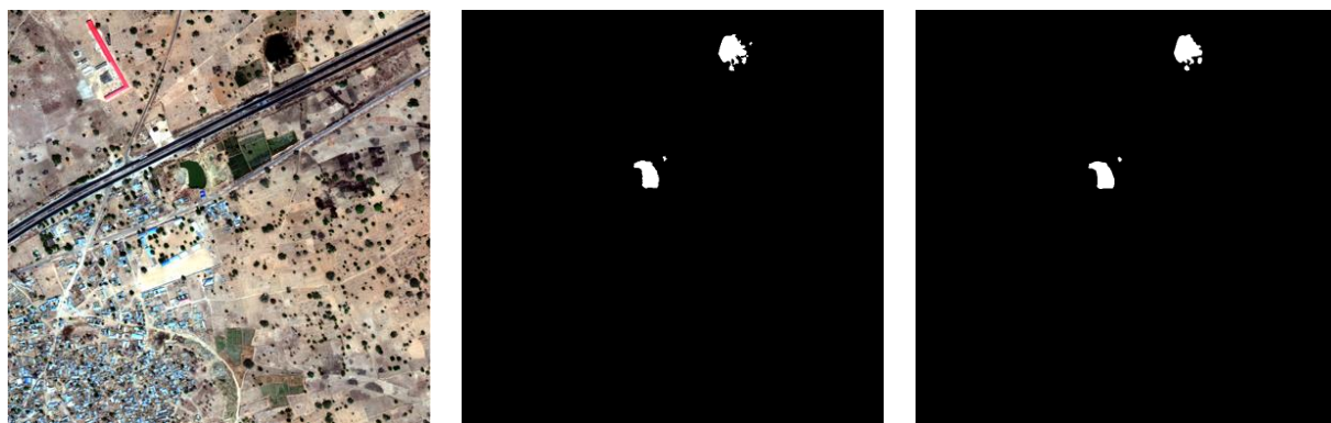
15 pav. U-Net vandens telkinių segmentavimo geriausias rezultatas
