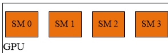
17 pav. GPU SM (multiprocesorių) loginė architektūra
