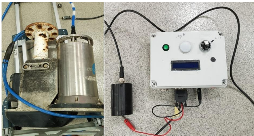
2 pav. Daugiaspindulinis echolotas „Geoswath“ (kairėje) ir automatinis vienspindulinis echolotas (dešinėje).
