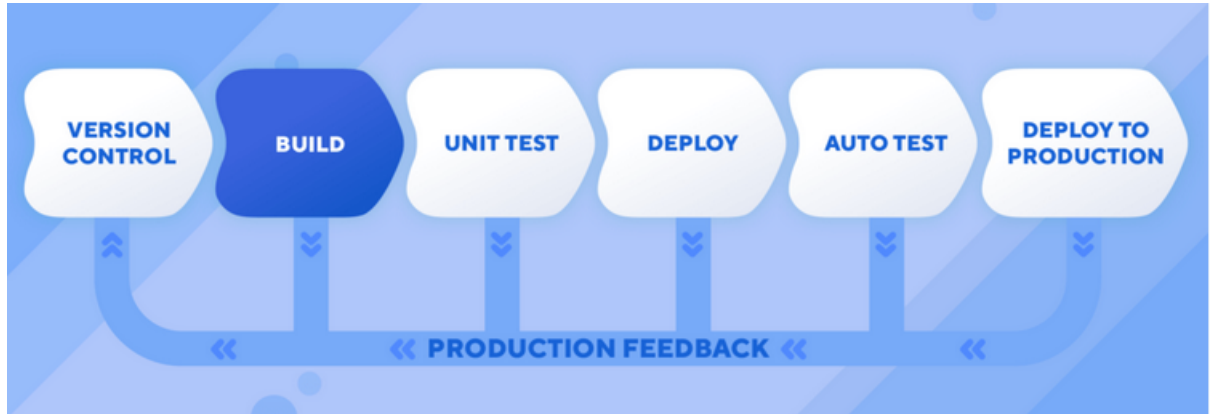
3 pav. Tipinio apibendrinto CI/CD proceso struktūra [LLC20b]. Versijavimo kontrolė, sudėjimas, vienetų testai, įdiegimas, automatiniai testai, įdiegimas į produkcinę aplinką
