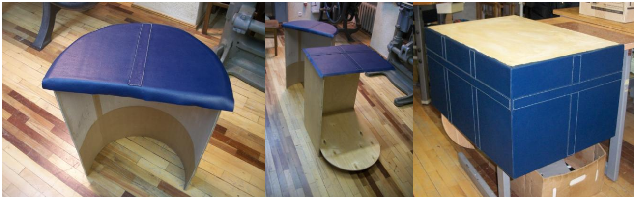
57 pav. Odos suklijavimas ant korpuso šoninių detalių
