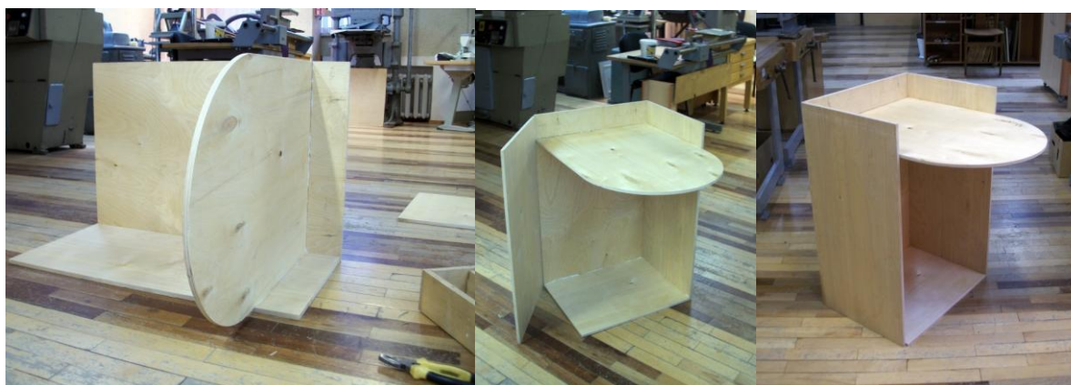
53 pav. Dėžės karkaso konstrukcijos tvirtinimas
