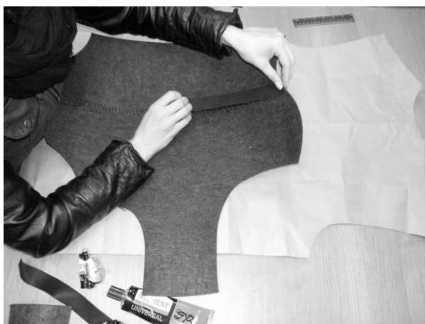
75 pav. Vidinių siūlių standinimas
