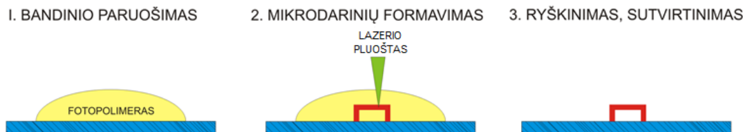
2.5 pav.: Daugiafotonės polimerizacijos technologijos etapai.
