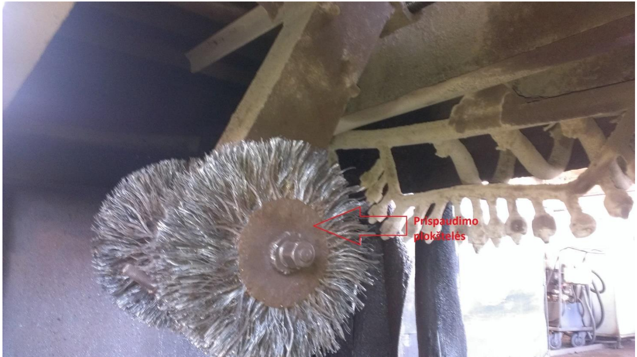
3.7 pav. AP mašinos valymo šepėčiai, vaizdas iš šono
