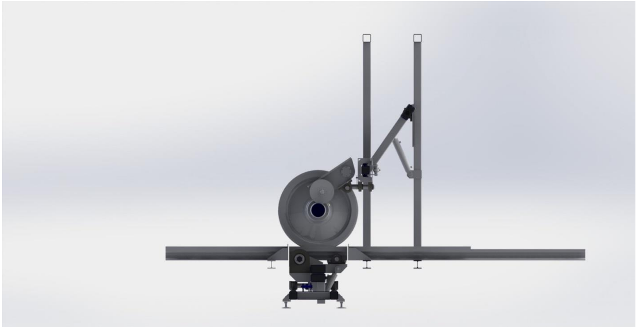
2.12 pav. Aširačio išvertimo mechanizmas vaizdas iš šono
