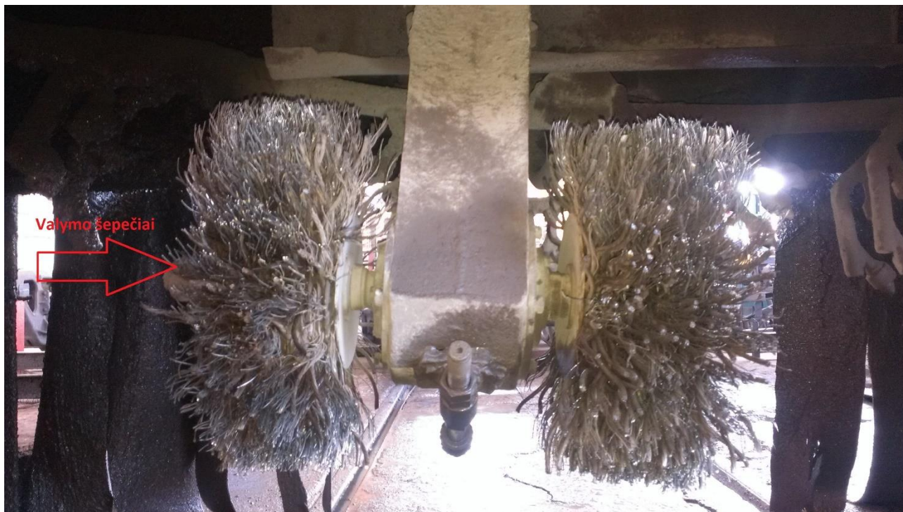
3.6 pav. AP mašinos valymo šepetiai, vaizdas iš priekio.
