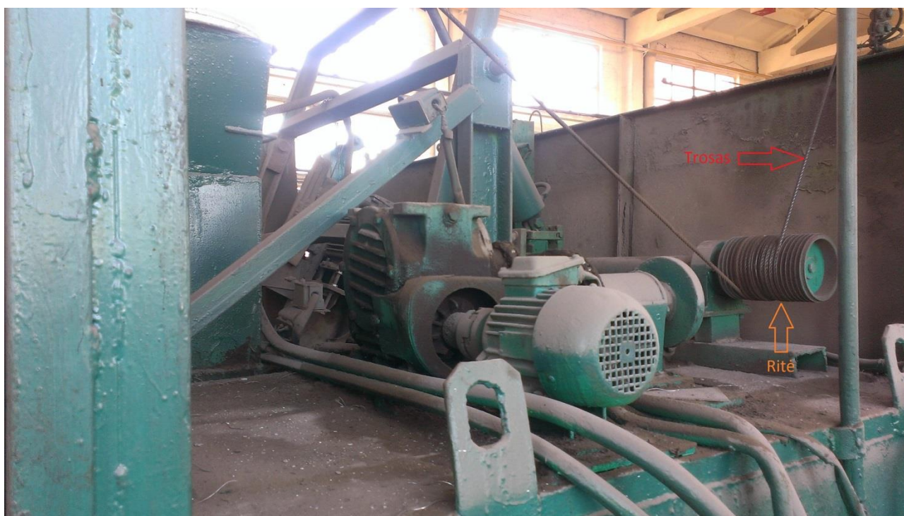
3.1 pav. Durų kilnojimo mechanizmas ir trosas
