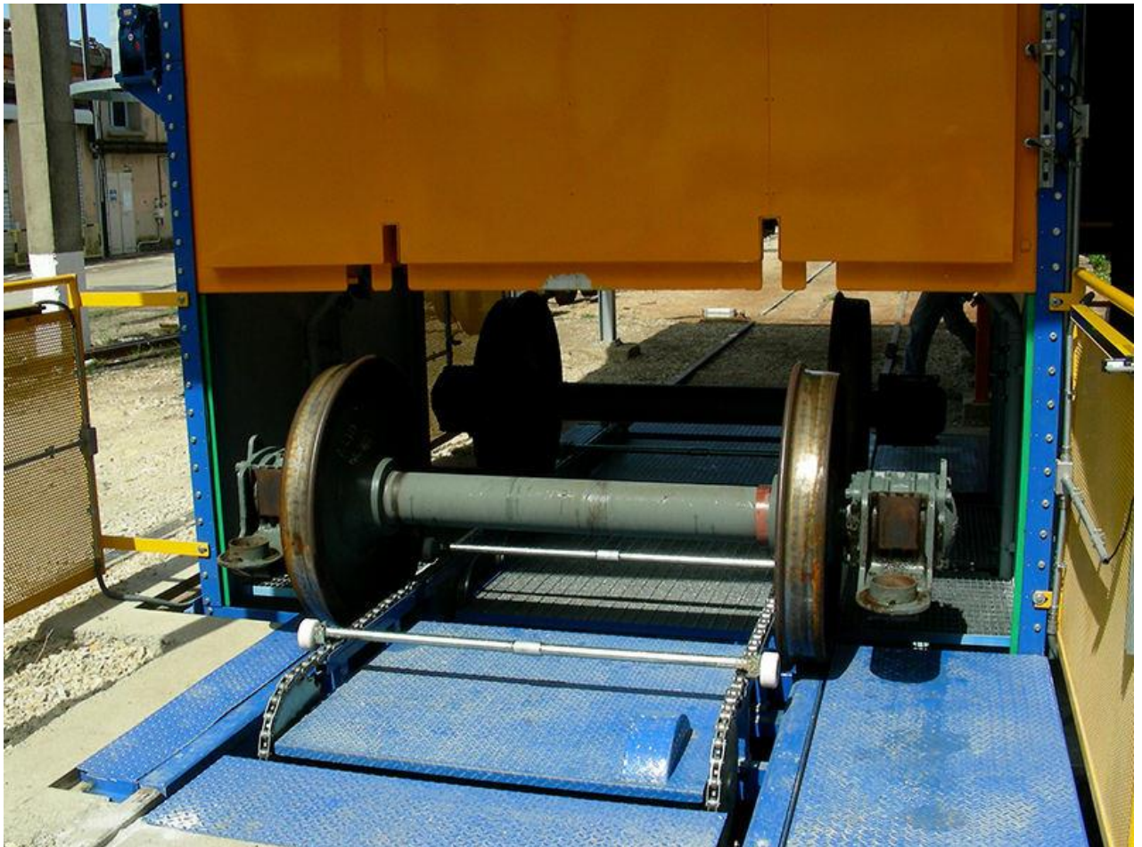
2.2 pav. Automatinis aširačio išridenimas
