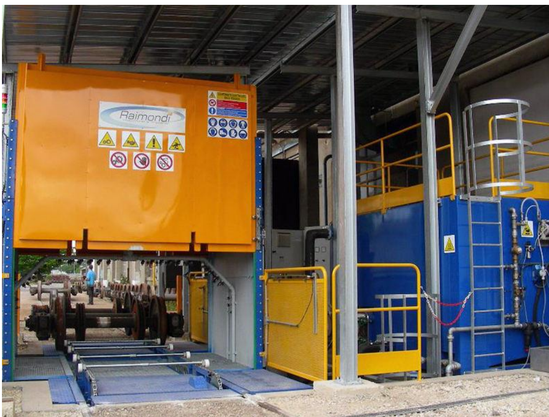
2.1 pav. Itališka aširačių plovimo mašina
