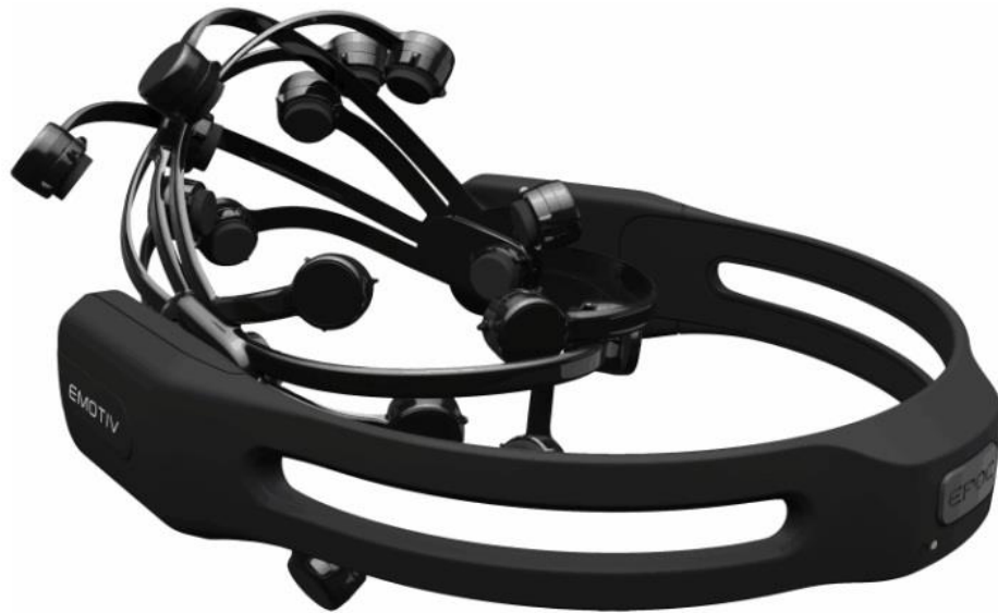
7. pav. Emotiv EPOC - EEG, EMG, EOG įrenginys[25]
